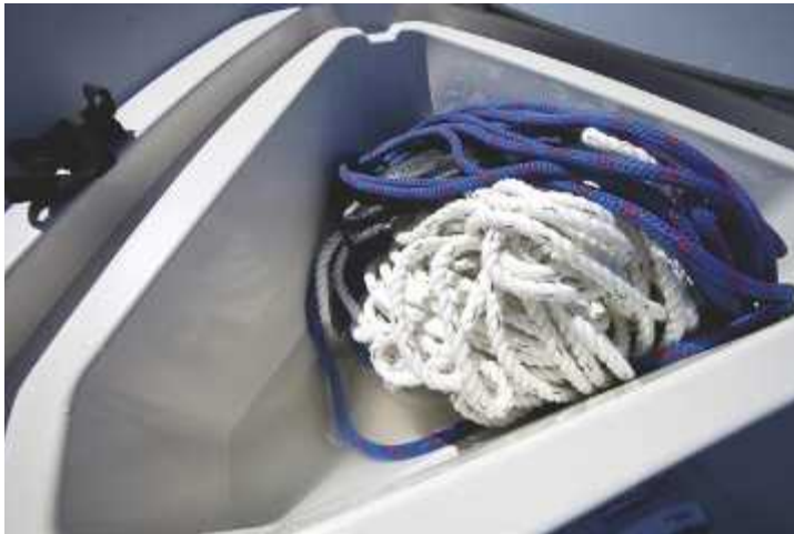
Köydelle jätetty aukko keulakotelon reunalla päästi vettä sisään. Ongelma korjataan seuraavaan tuotantoeraan.
