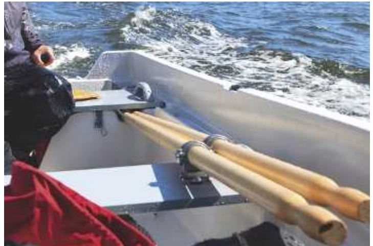
Airon hankaimet saa keskituhdon reikiin ja lavat peräpenkin alle. Siten ne voidaan myös lukita, kun vene jää rantaan.
