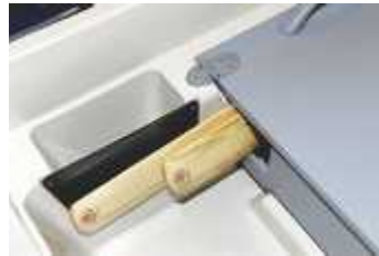
Airon hankaimet saa keskituhdon reikiin ja lavat peräpenkin alle. Siten ne voidaan myös lukita, kun vene jää rantaan.
